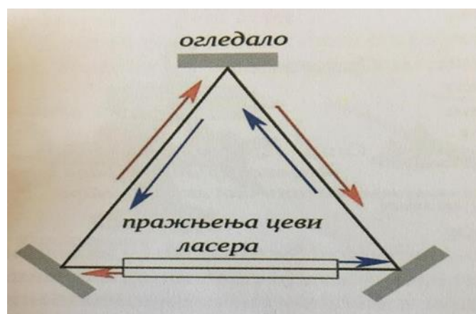
Слика 40. Принцип рада жироскопа са ласерским радом
