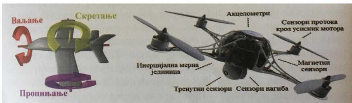
Слика 37. Поглед на слободу кретања дуж и ротације око три осе авиона
