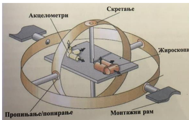
Слика 59. Инерцијални инструмент и инерцијална мерна јединица и инерцијални облици
