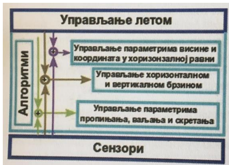
Слика 65. Типична шема БПЛ контроле лета аутопилота
