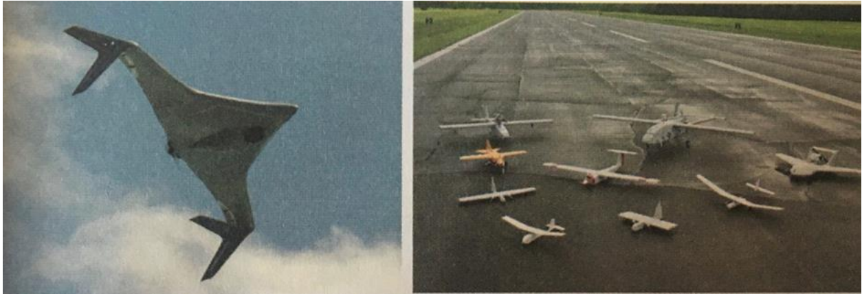
Слика 7 лево. Груманов БПЛ носи EO/IR и SAR сензоре, ласерски даљиномер, ласерски маркер и инфрацрвену (IR) камеру, десно: изложба америчких БПЛ-а 2005.
