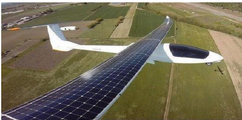
Слика 34. Соларни панели на ваздухоплову
