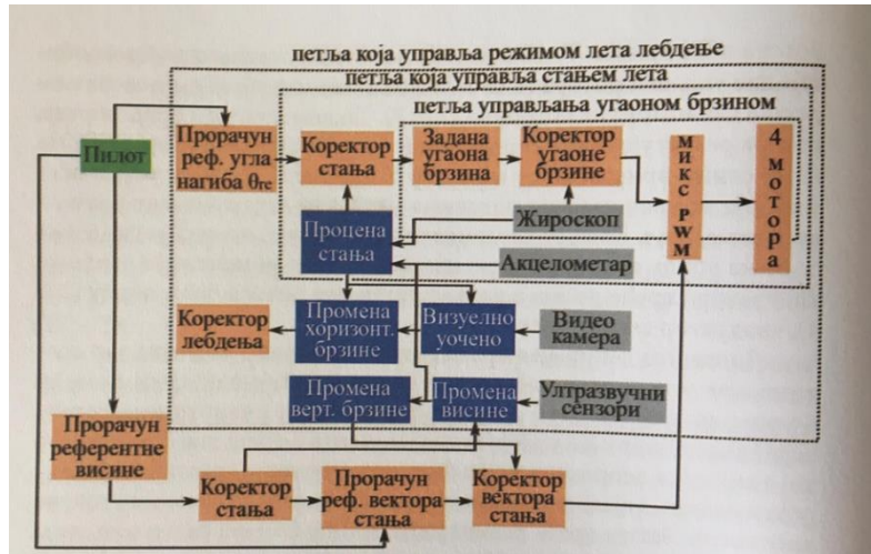
Слика 81. Архитектура фузије података и управљања БПЛ, квадратура
