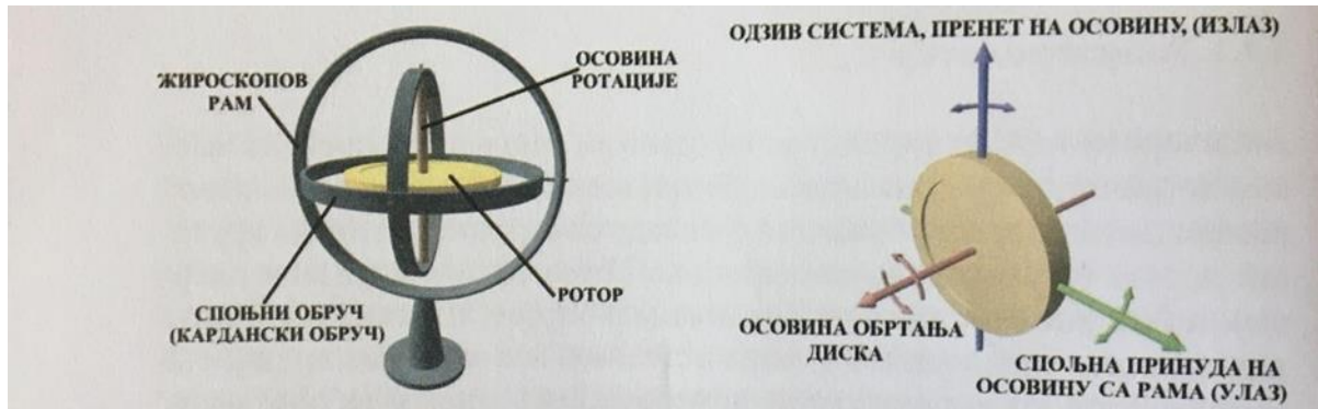
Слика 39. лево: принцип рада механичког жироскопа са карданским механизмом, са три слободна прстена; десно: принцип одзива механизма жироскопа на спољашњу принуду
