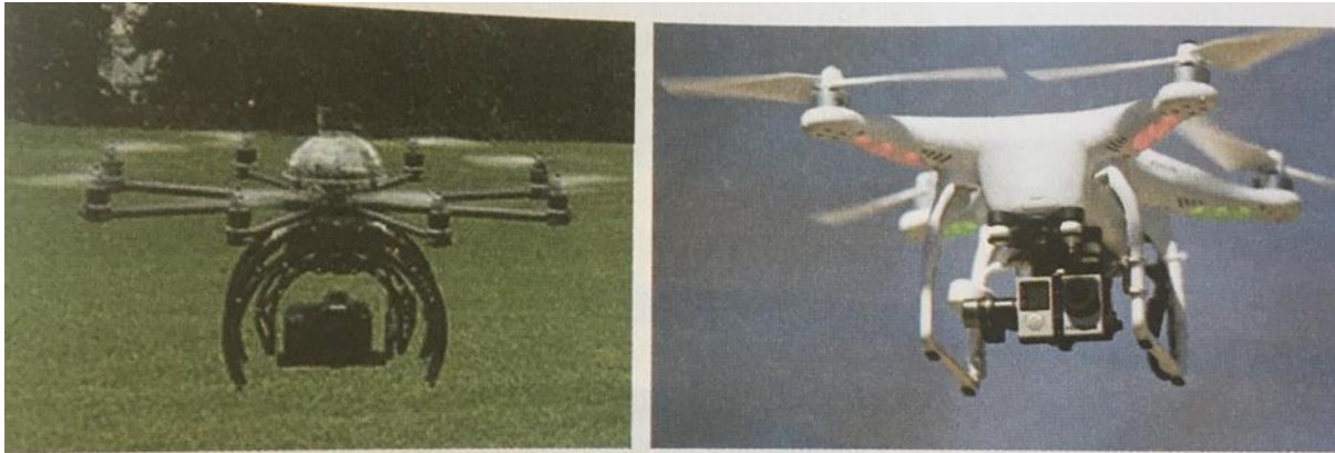
Слика 109. БПЛ са осам ротора ; Комерцијални БПЛ (квадрокоптер, опремљен је камером производа од кинески од ДЈИ)
